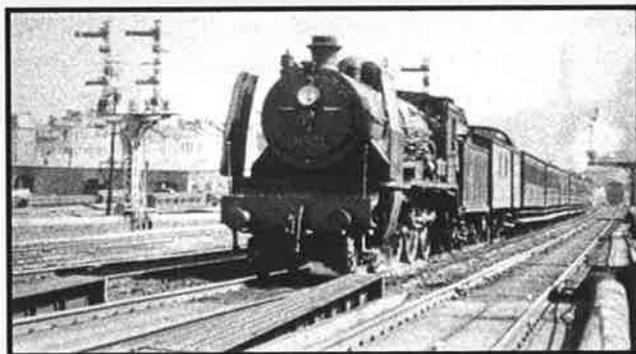
**Locomotive type 9, n°9.021, de la remise de Landen en tête d'une rame composée d'un fourgon et de voitures GCl venant de démarrer de la gare de Liège-Guillemins et s'appêtant à attaquer la longue montée des plans inclinés, sans doute aidée par une, voire deux, locomotives de pousse.**
